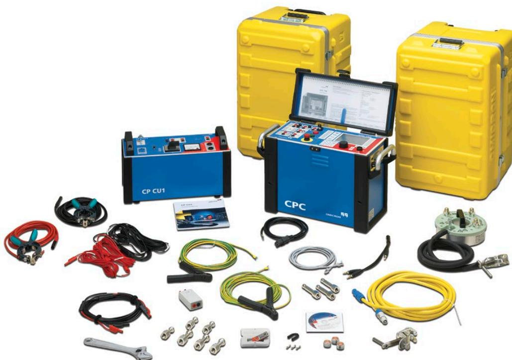
Sistema de prueba de impedancia de línea CPC 100 (Nº de pedido VE000602)
